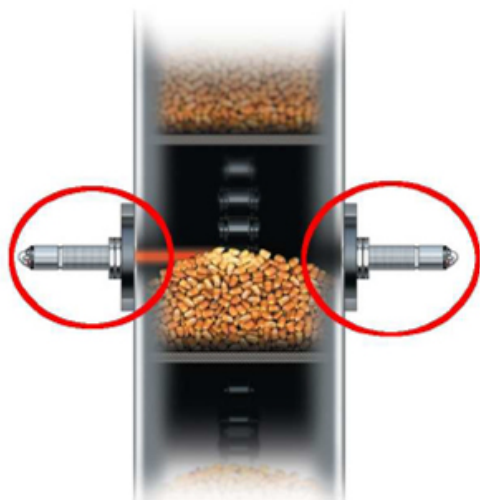
Fig.3. Udbyttet opgøres ved infrarød måling af rumfanget. Foto: Claas
